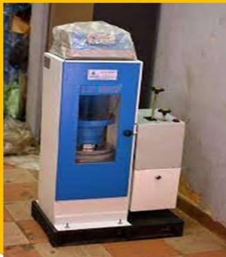
تستخدم في قياس جهد الكسر للعينات الصخرية او الخرسانية المكعبة لمعرفة قوة تحملها
