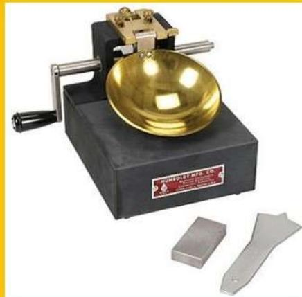
يستخدم الجهاز في إيجاد حد السيولة وحد اللدونة للترية وتسمى بحدود اتربرج "Atterberg Limits"
